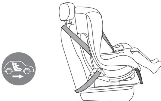
**NOTA: El cinturón del automóvil debe estar bien tirante cuidando que las cinturas no estén torcidas. La silla de seguridad DEBE estar colocada para el Grupo I, en el sentido de marcha del automóvil. El airbag DEBE estar desactivado.**
