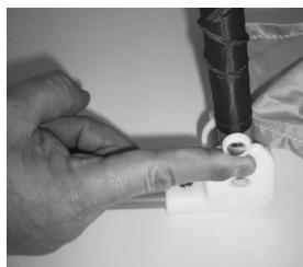
1. Liberar tirando de los dos mecanismos colocados a ambos lados del soporte de plástica.
