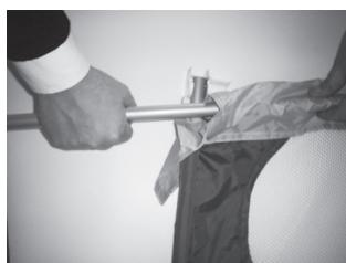
4. Inserire I tubi assemblati nel manicotti inferiori della barriera
