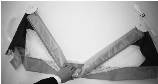
4. Premere il tasto posto sotto il cerchio con la scritta "PRESS TO UNLOCK" e chiudere completamente la parte superiore della barriera.
