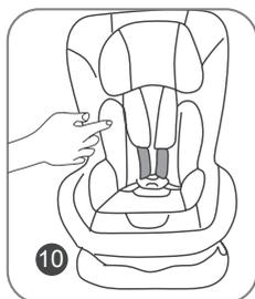
B) Appuyez sur la manette pour le réglage de l'inclinaison du siège d'enfant et tirez pour atteindre la position d'inclinaison maximale du siège. (FIG.11)
