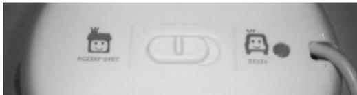
По време на фазата на затопляне, след като уредът вече е достигнал желаната температура, освен по време на функцията за стерилизиране, светлината, отговаряща на РЕЖИМ „У ДОМА“ или РЕЖИМ „В КОЛА“ ще се изключи, след това **ЗАВЪРТЕТЕ РОТАЦИОННИЯ БУТОН НА ПОЗИЦИЯ OFF, ЗА ДА ИЗКЛУЧИТЕ УРЕДА.**
