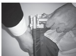
5. Accrocher le bouton à ressort situé à l'extrémité des tubes dans le support plastique
